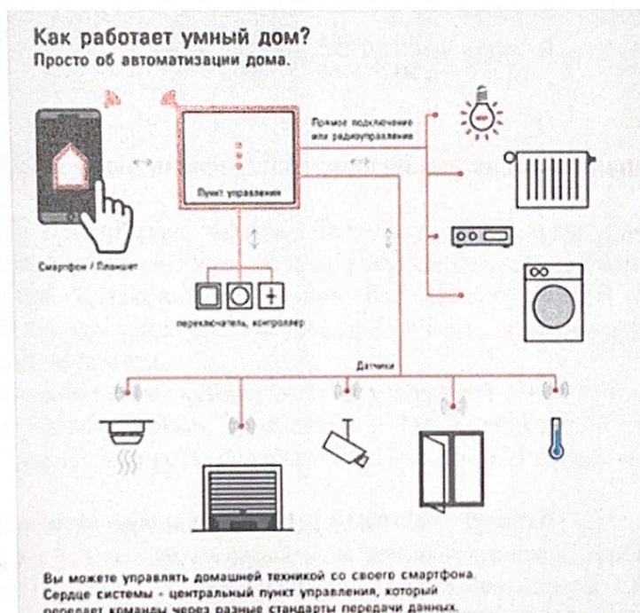
Сурет 1-Ақылды үй жүйесінің жұмыс жасау үлгісі
